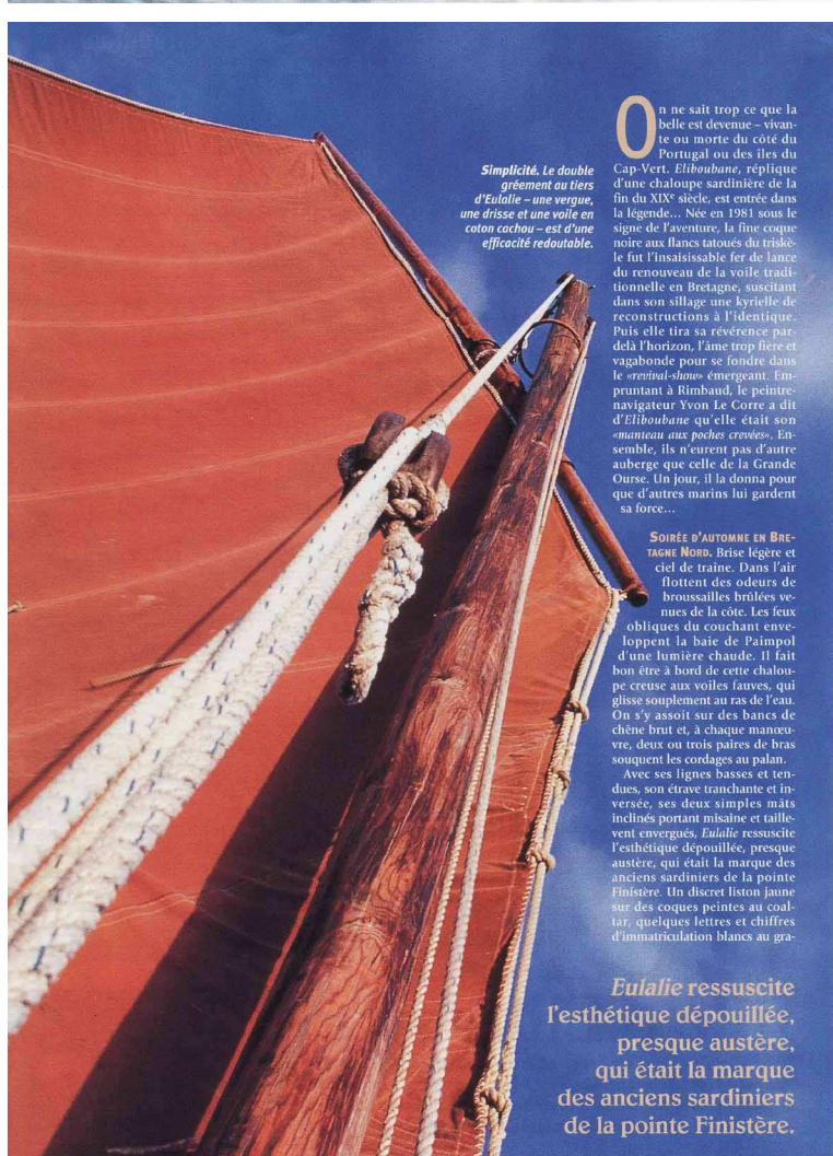
Puissance. Le double gréement au tiers, où la misaine sert de foc, permet à cette chaloupe de marier cap et vitesse.
