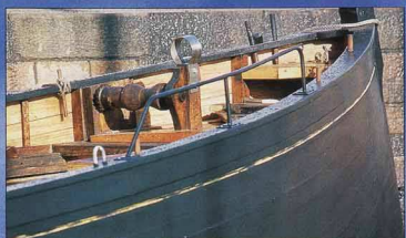
Accostillage. Le robuste guindeau n'est pas de trop pour remonter l'ancre.
