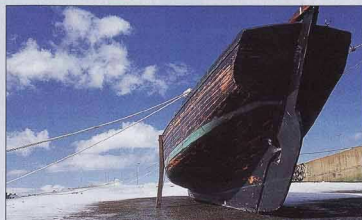
Carénage hivernal. La carène en chêne, issue d'un plan relevé en 1900, demande un entretien attentif.
